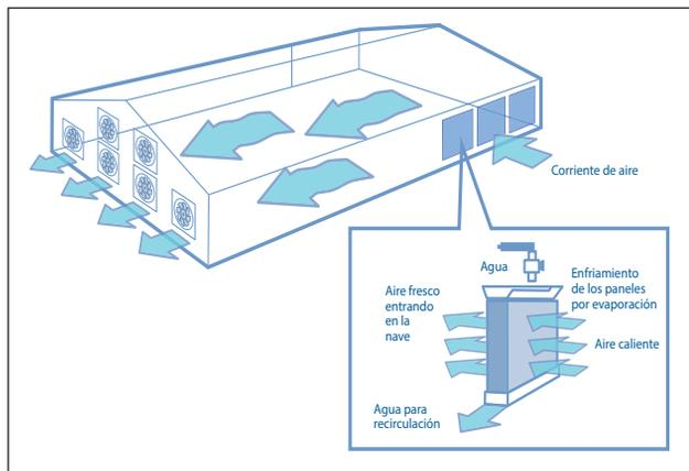
**Figura 14: Enfriamiento por paneles con ventilación tipo túnel**
