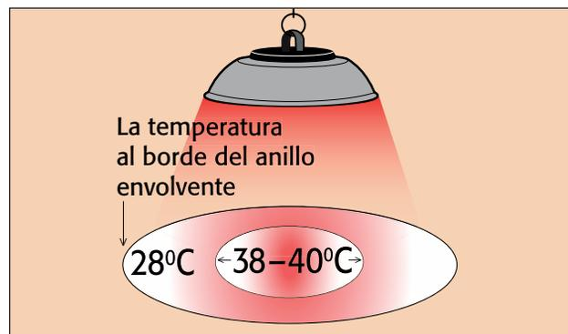
Figura 8. Temperatura debajo de la campana de calor
