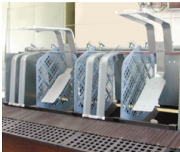
*Рисунок 21. Пример системы батареи автоматических гнезд с мостиками и механизмами «сталкивания с гнезд» (Фото любезно предоставлено MGH)*
