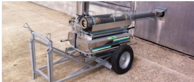
Рисунок 3. Генератор горячего тумана (Фото любезно предоставлено Agrex Limited)
