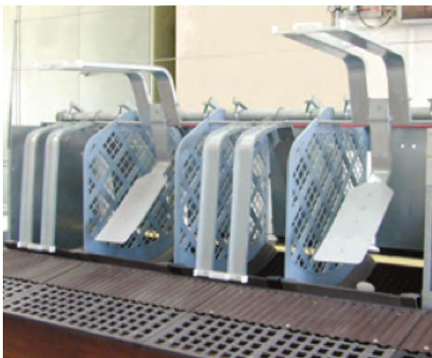
**Рисунок 21.** Пример системы батареи автоматических гнезд с мостиками и механизмами «стакивания с гнезд» (Фото любезно предоставлено MGH)
