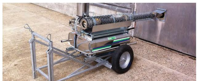
Рисунок 3. Генератор горячего тумана (Фото любезно предоставлено Agrex Limited)
