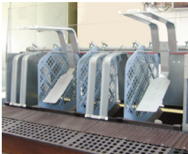
Rysunek 21. Przykład automatycznego systemu gniazdowego przedstawiającego mechanizmy wypychania z gniazda i odgania z rampy (dzięki uprzejmości MGH)
