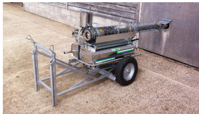
Rysunek 3. Zamglawiacz termiczny (Dzięki uprzejmości Agrex Limited)
