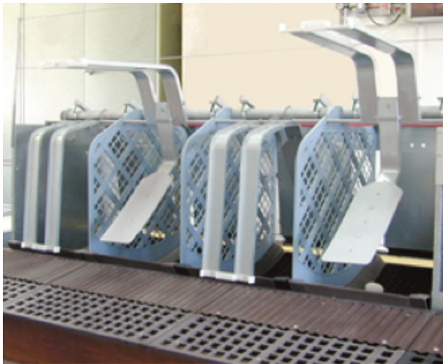
Illustration 21. Exemple d'un système de pondoires automatiques avec rampes et mécanismes d'expulsion (photo de MGH)
